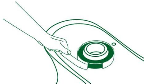
3° - Verifique se o anel está centralizado à saída do vaso e grudado, em seguida centralize a saída do vaso com o tubo de esgoto no piso e encaixe;
