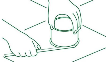
2° - Retire a proteção que envolve o anel de vedação, fixando-o na saída do vaso sanitário com a guia para fora;
