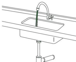
8° Finalize limpando o sifão, a válvula da pia e a ligação na parede.
