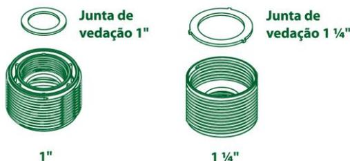
2° Para fazer a ligação: Em válvulas para pias e lavatórios (1" (7/8)) e tanques (1.¼), instale o adaptador roscável na válvula e, depois, rosqueie a sobreporca no adaptador roscável. Em válvulas para pia americana (1.½), rosqueie a sobreporca diretamente na válvula;
