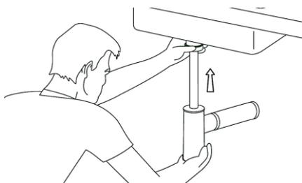
6° Encaixe o tubo de saída na saída de esgoto. Ajuste o sistema para que fique no nível e no prumo. Aperte todos os componentes;
