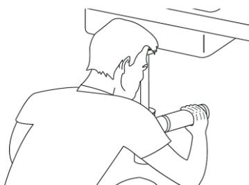
7° Verifique se há vazamento no sistema abrindo a torneira. Em caso positivo, remonte-o apertando todos os componentes;
