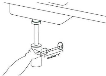
4° Se necessário, corte o tubo de saída deixando-o na medida exata;
