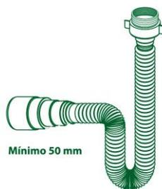
4° Verifique o diâmetro do ponto de esgoto e encaixe o terminal luneta no diâmetro correspondente.
