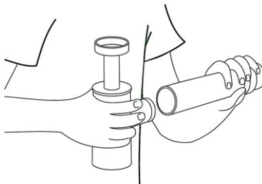
2° Monte o sifão deixando as peças frouxas para que o ajuste seja feito ao final da instalação. Rosqueie provisoriamente o Sifão na válvula de escoamento da pia;
