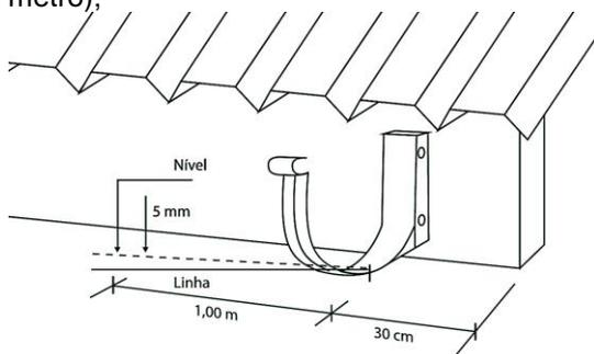
3° A linha servirá como base para colocação dos suportes intermediários, sendo que o espaçamento máximo entre eles deverá ser de 60 cm;
