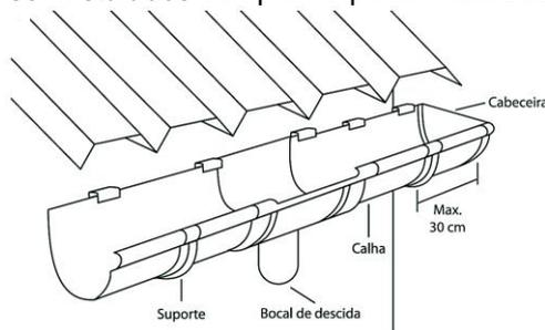
5° Inicie a colocação da calha: fixe a borda interna (reta) da calha no suporte, girando-a em seguida para baixo até encaixar a borda externa (redonda);
