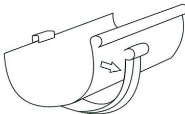
6° As conexões devem ser fixadas na própria calha, como no item anterior, usando sempre a vedação para calha pluvial;
