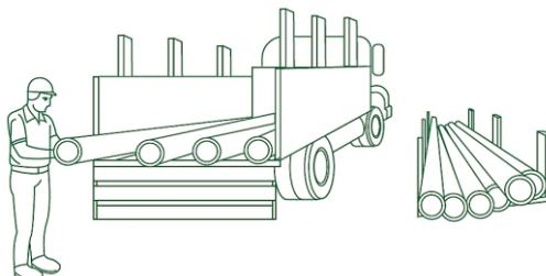
O local de armazenamento deve ser plano e bem nivelado, para evitar deformações permanentes.
