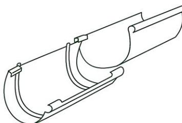
7° Para trechos de calhas menores que 3 metros, marque com um lápis e corte o perfil com serra metálica;
