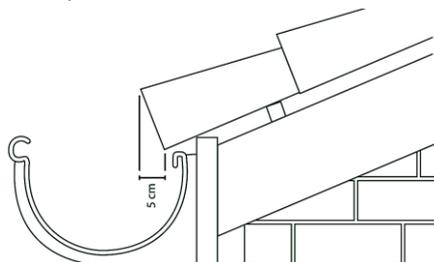
2° Para fixação do suporte, escolha o ponto mais alto da instalação a 30 cm da extremidade do beiral, amarre a linha no suporte e estique até o último suporte do trecho, ponto mais baixo, com inclinação mínima de 0,5% (5 mm a cada metro);
