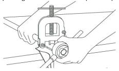
3° Girar uma volta e retornar 1/4 de volta, para retirar as rebarbas da rosca;
