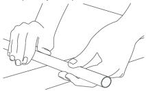
2º Com uma tarraxa para PVC, acoplar o guia e o cossinete específico para eletrodutos;
