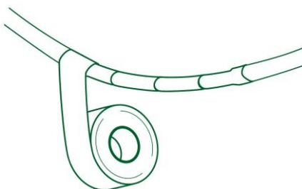
3º Cubra a parte a ser isolada completamente exercendo uma leve pressão sobre o material.
