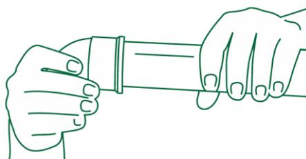
**5º-** Remover o excesso de Adesivo Plástico PVC e deixar secar. Aguardar 12 horas para submeter a tubulação à pressão.
