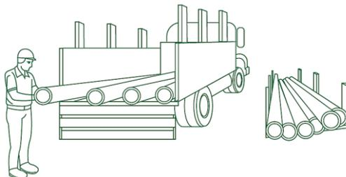
O local de armazenamento deve ser plano e bem nivelado, para evitar deformações permanentes nos tubos. Os tubos devem ser estocados com pontas e bolsas alternadas, sem que as bolsas encostem umas nas outras. A primeira fileira deverá estar apoiada sobre uma estrutura de madeira, sendo que a pilha total não deve exceder 1,5 metro de altura.
