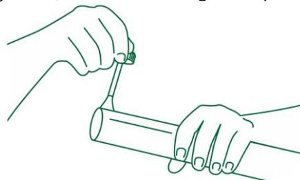
**4º-** Juntar as duas peças, forçando o encaixe até o fundo da bolsa, sem torcer;
