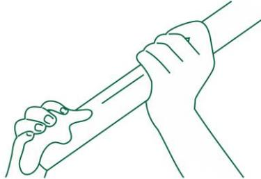
**3º-** Aplicar com pincel uma camada fina e uniforme de Adesivo Plástico PVC Amanco na parte interna da bolsa da conexão, cobrindo um terço dela, e uma camada igual na parte externa do tubo;
