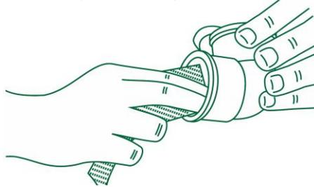
**2º-** Limpar as superfícies lixadas com Solução preparadora Amanco, eliminando as impurezas que podem impedir a ação do Adesivo Plástico PVC Amanco. Esta ação prepara o PVC para a soldagem.
