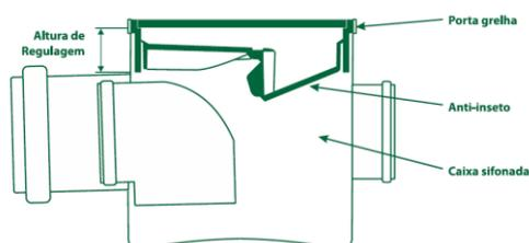
**OBS:** Caso durante a instalação do anti-inseto esteja com dificuldade de inserção na parede interna do porta-grelha, amasse a aba flexível lateral do anti-inseto para facilitar a montagem.
