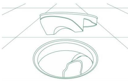
4° - Ajuste o anti-inseto na caixa sifonada para acertar com o sifão já instalado, girando se necessário. Pressione o anti-inseto até estar corretamente fixado e nivelado dentro do porta-grelha, ajustando a altura de instalação na parede interna do porta-grelha. O ANTI-INSETO NÃO PODE FICAR SOLTO NO PORTA-GRELHA.
