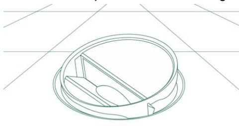
5° - Após a montagem encaixe a grelha novamente no porta-grelha da caixa sifonada.
