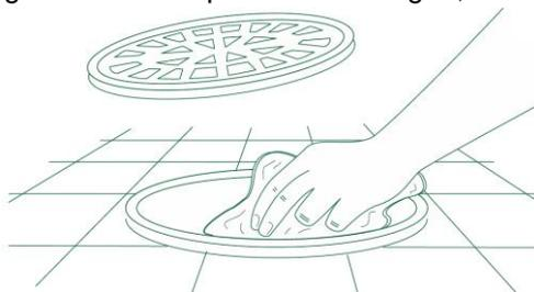
3° - Encaixe o anti-inseto no porta-grelha sob pressão, para ficar bem preso ao diâmetro interno do porta grelha;
