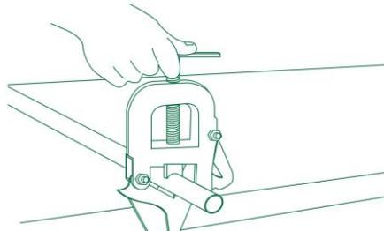
3° Monte a tarraxa observando a colocação correta do cossinete, coloque-a no tubo fazendo uma pressão com uma das mãos e girando a ferramenta no sentido horário;
