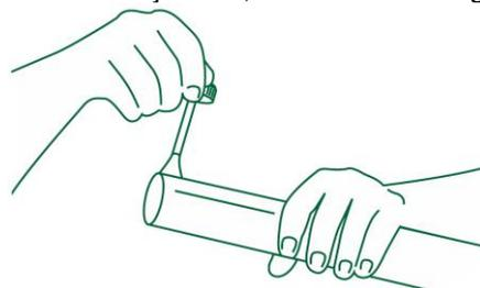
5º Juntar as duas peças, forçando o encaixe até o fundo da bolsa, sem torcer;
