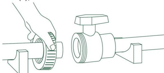
7º Aplicar adesivo e soldar a bolsa soldável (2) na seção A;
