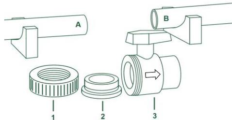
4º Aplicar com pincel uma camada fina e uniforme de Adesivo Plástico PVC Amanco na parte interna da bolsa do corpo do registro (3), cobrindo um terço dela, e uma camada igual na parte externa do tubo B;
