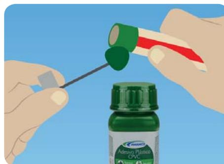
**d)** Encaixe as duas peças, dê ¼ de volta e pressione-as por aproximadamente 30 segundos. Remova o excesso com um pano (pode ser estopa ou flanela) e deixe secar.
