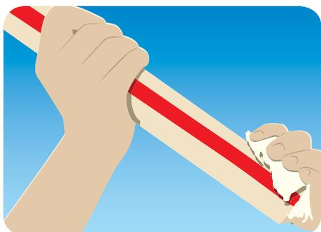
**b)** Confira o ajuste entre a ponta do tubo e a bolsa da conexão antes de iniciar a execução da junta soldável. Deve existir uma interferência entre as peças para que a pressão auxilie na união dos tubos. Uma boa interferência ocorre quando a ponta do tubo ocupa de 1/3 a 2/3 do comprimento total de soldagem da bolsa.
