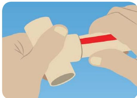
**c)** Com o auxílio do pincel, aplique uma camada fina e uniforme de Amanco Adesivo Plástico CPVC na bolsa da conexão e na ponta do tubo. Passe o adesivo em ambas as partes, mas sem excesso, para garantir uma soldagem perfeita.
