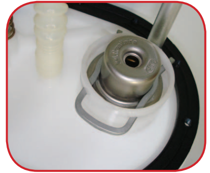
No módulo de combustível, junto à bomba de combustível (sistema multiponto returnless)
