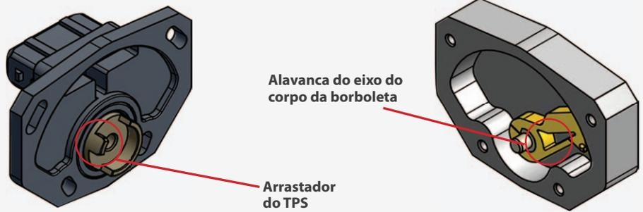
**5º passo:** Encaixe os parafusos no centro do rasgo de regulagem e apenas encoste deixando o TPS livre para posterior ajuste.
