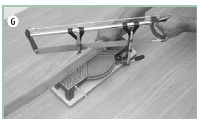
Obs.: para que o corte fique com um acabamento perfeito (foto 5), é necessário que seja feita uma "afiação" da serra, removendo os dentes originais e transformando-a em uma "lâmina de faca" (foto 6).
