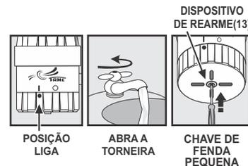
Sua finalidade é destravar o pistão em locais com baixa pressão de água. Para isso, coloque a Tampa/Chave Seletora na posição ( / ) "Liga" abra o registro, fazendo circular água pelo aparelho e pressione o Dispositivo de Rearme(13) com uma chave de fenda pequena.
