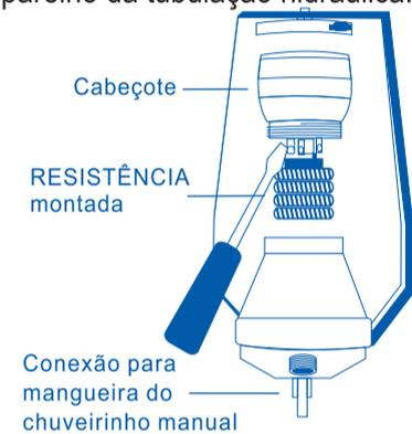
Recoloque o bojo no cabeçote girando-o à direita. Reponha o painel frontal, o acabamento do seletor de temperatura e a mangueira do chuveirinho manual. Rosqueie a porca fixadora do chuveirinho dirigível ao bojo, observando o uso da guarnição para vedação. Deixe correr água por alguns segundos **antes** de religar o circuito elétrico.
