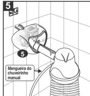
5 Coloque a mangueira do chuveirinho manual na Ducha/Chuveiro (quando houver), abra o registro de água, sem ainda encaixar o painel (5), para verificar eventuais vazamentos. Não ocorrendo nenhum vazamento, proceda a instalação da Eletrobomba Jato Forte FAME à rede elétrica.
