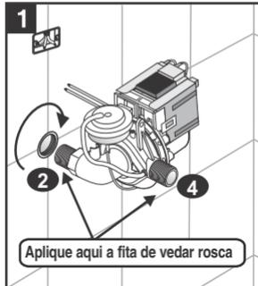
1 Limpe a saída da conexão hidráulica onde vai ser instalado o aparelho. Abra o registro deixando correr a água para eliminar completamente os possíveis resíduos acumulados na tubulação. Certifique-se de que o circuito elétrico que comandará este aparelho está desligado.
