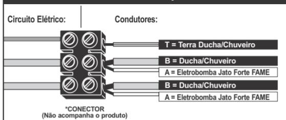
Conecte os cabos de ligação utilizando preferencialmente conectores FAME (não acompanha o produto), sendo que para cada cabo de ligação da Ducha/Chuveiro (A) une-se com um cabo para ligação da Eletrobomba Jato Forte (B), e o cabo verde/amarelo da ducha/chuveiro liga-se ao sistema de aterramento (T).
