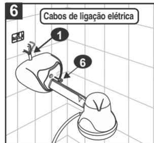
6 Encaixe definitivamente o painel, utilizando o parafuso de fixação (6), não se esquecendo de deixar todos os cabos de ligação elétrica (1) para fora do painel como mostram as figuras.
