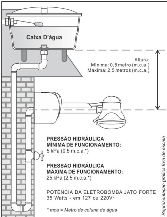
A Eletrobomba Jato Forte FAME é indicada para instalações onde o volume ou pressão de água forem baixos ou insuficientes, podendo ser ligada à maioria dos modelos de DUCHAS POPULARES e chuveiros elétricos. A pressão mínima de funcionamento é de 0,5 m.c.a. (metro de coluna de água) e a máxima 2,5 m.c.a. (Metros de coluna de água). A Eletrobomba Jato Forte FAME é automática, liga e desliga-se com a abertura / fechamento do registro de água.
