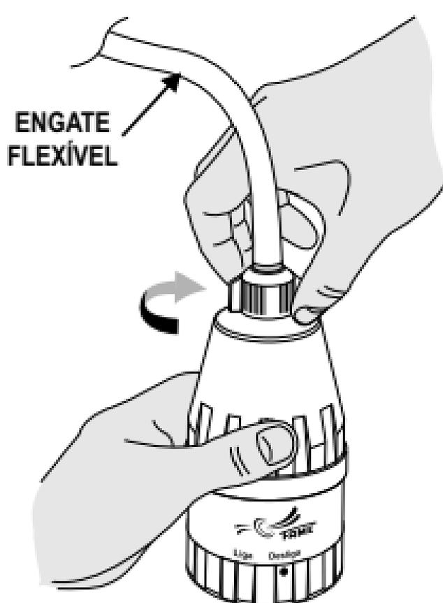
Recoloque com as mãos a Porca do Engate Flexível no Niple da saída de água do Bojo. Observe o uso da guarnição para vedação.
