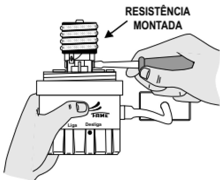
Afrouxe com a chave de fenda/philips os dois parafusos que fixam a Resistência montada avariada, retirando-a. Limpe as áreas de contato elétrico e encaixe a nova Resistência na mesma posição, reapertando os dois parafusos.
