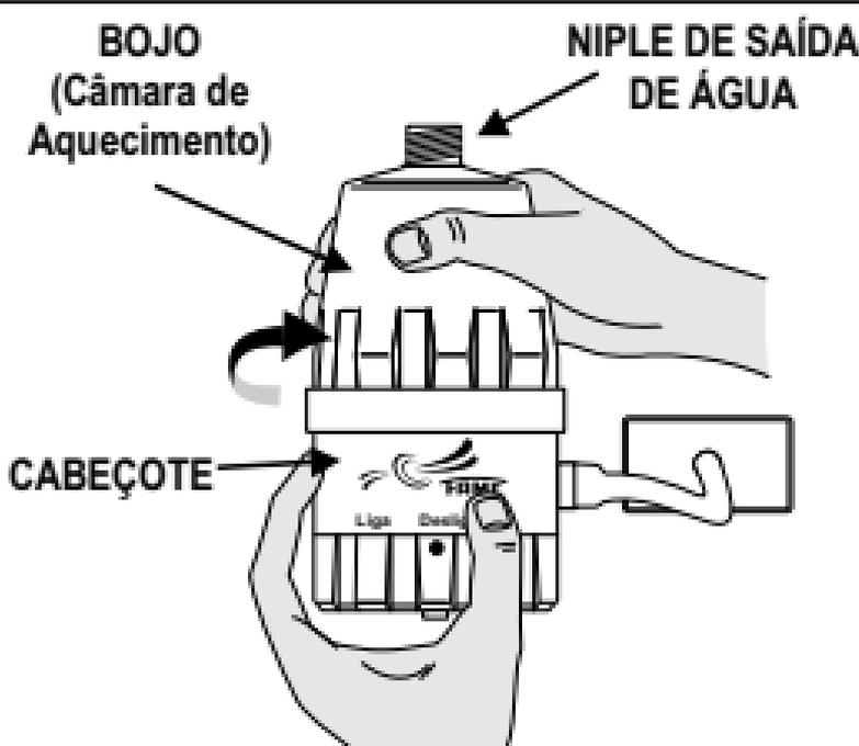
Desrosqueie com as mãos o Bojo, girando-o no sentido anti-horário separando-o do Cabeçote, tendo assim acesso à Resistência Montada. Observe como a Resistência está fixada por dois parafusos aos contatos-ponte, para que possa retorná-la à mesma posição.
