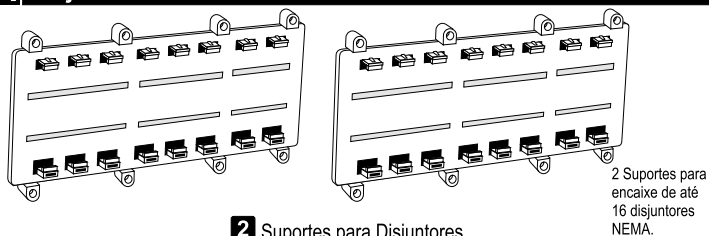
2 Suportes para Disjuntores
