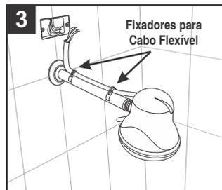
Utilize os Fixadores para encaixar o cabo flexível da ducha/chuveiro instalado no Cano FAME. Finalize a instalação da ducha/chuveiro conforme seu manual de instrução.
