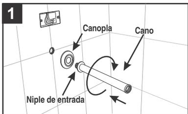
Limpe a saída da conexão hidráulica onde será instalado o produto. **Abra o registro** deixando correr a água para eliminar completamente os possíveis resíduos acumulados na tubulação. Verifique o diâmetro da conexão hidráulica, que deve ser de 1/2" GÁS.
