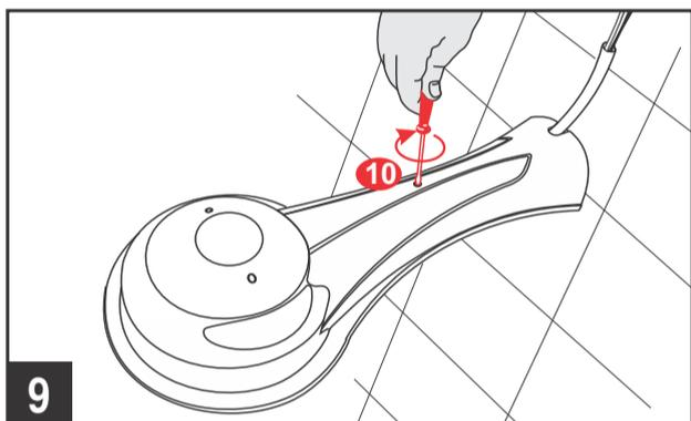
**9** Com o auxílio de uma chave fenda/philips, aperte o Parafuso (10) fixando o Acabamento no Chassi.
