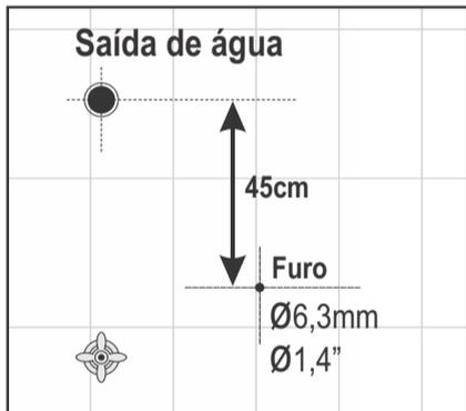
Instale o suporte do Chuveirinho Manual Quick, a mais ou menos 45cm abaixo da conexão hidráulica, usando brocas de Ø6,3mm ou Ø 1/4", tomando cuidado para não perfurar o encanamento.
