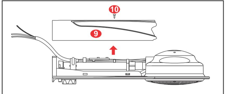
Com o auxílio de uma chave de fenda/phillips, remova o Parafuso (11) e retire o Acabamento (10) da Ducha Elegance Eletrônica FAME.
