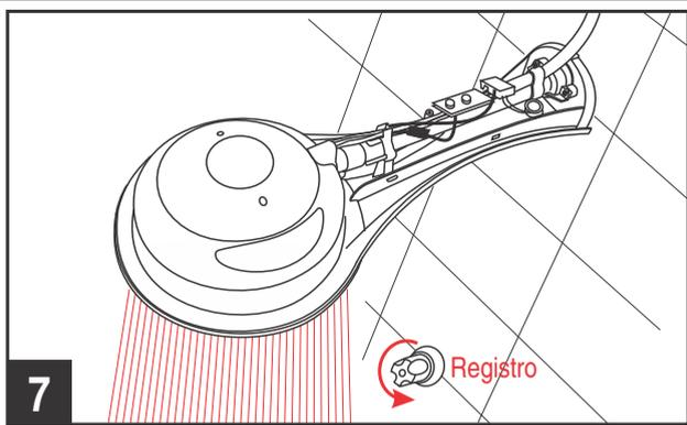
**7** Abra o registro e deixe a água escorrer por alguns segundos. Essa operação tem a finalidade de encher o Bojo (11), para evitar danos à Resistência e verificar se há vazamentos. **Em caso de vazamento, corrija o mesmo antes de prosseguir com a instalação.**
