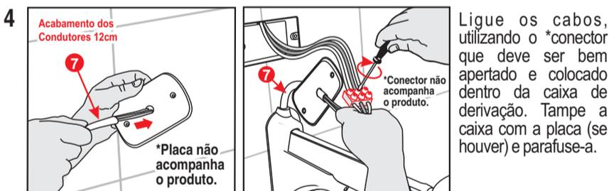
Coloque o Acabamento de 12cm dos Condutores de ligação (7), passe o conjunto (Isolador + cabos + aterramento) da Ducha Evidence Eletrônica pela \*placa (se houver).
