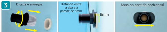
Enrosque o engate fácil na parede, respeitando a distância de 5mm da aba até a parede, e com as abas no sentido horizontal.
