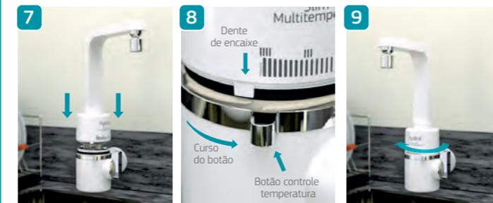
Verifique se a chave seletora está no final do curso a direita. A tampa superior possui um dente que deverá encaixar no corpo antes da chave seletora de temperatura. Encaixe e gire no sentido horário para junção da tampa superior e o corpo. Ligar o disjuntor e verifique o funcionamento.
