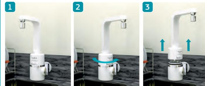
Segure a tampa superior e gire anti-horário. O dispositivo irá girar automaticamente a chave seletora de temperatura para a posição "1" desligado. A mesma deve ficar nesta posição até a conclusão da instalação. Após este movimento, puxe suavemente a tampa superior para cima, removendo-a com a bica.
