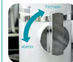
Para abrir e fechar, gire o registro para o sentido anti-horário (abrir) e horário (fechar). É possível regular a vazão da torneira através do registro, por ele, pode-se controlar a quantidade de água que sai da torneira. A medida que gira o registro para a esquerda, aumenta a vazão, atingindo a vazão máxima ao girar 90°.
